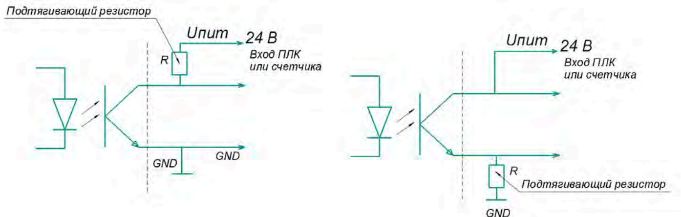
Рисунок 21 – Схема подключения дискретного выхода «OUT1»
