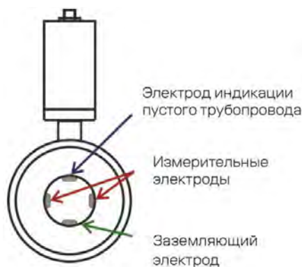
Рисунок 16 – Схема расположения электродов расходомера
